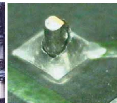
アルミ電解コンデンサの液漏れによる絶縁劣化・パターン剥離
