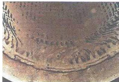
洗浄後の絶縁損傷状況
